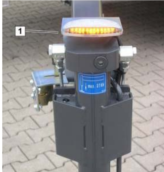
Abb. 119: Blinkleuchte auf der Stütze
